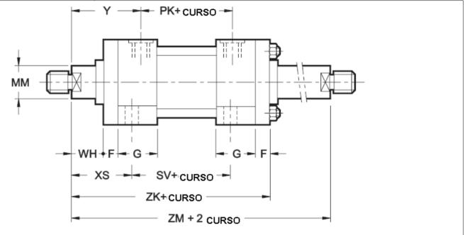
Para outras cotas e tipos de fixações, ver a tabela que se refere ao tipo de cilindro da haste simples. Não disponível com fixações C-D-F. As normas do cabeçote traseiro para as conexões B e N são iguais às do cabeçote dianteiro no que se refere às conexões A e H.
